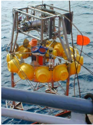
Punktgenaues Absetzen des Landers Auf Schiffsposition erfolgt durch das video-gesteuerte Absatzgestell.
