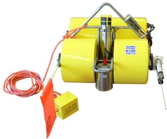
Lobster-ultra-deep, Kurzzeit, (Vorderansicht) mit Releaser, Breitbandseismometer, Hydrofon, Blitzer, Sender
